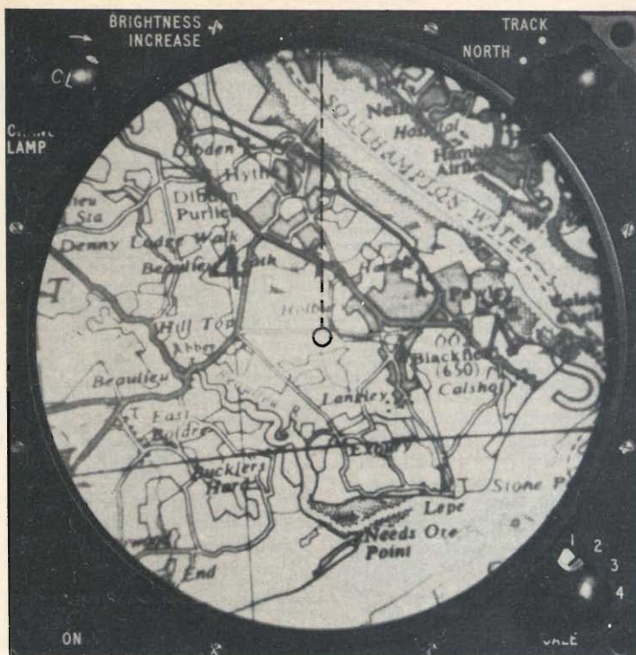
Fig. 6 - Indicatore di posizione e di rotta di un aereo su carta geografica mediante l'impiego di un calcolatore elettronico.
