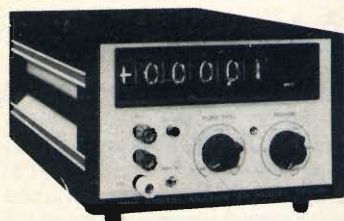
Fig. 11 - Multimetro digitale allo stato solido FAIRCHILD modello 7000A.
